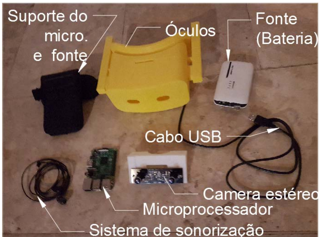
Figura 33 - Equipamento utilizado para construção do protótipo
