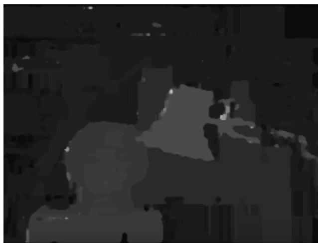
Figura 14– Mapa de disparidade da imagem de validação utilizando o algoritmo utilizando abordagem de K-Means.
