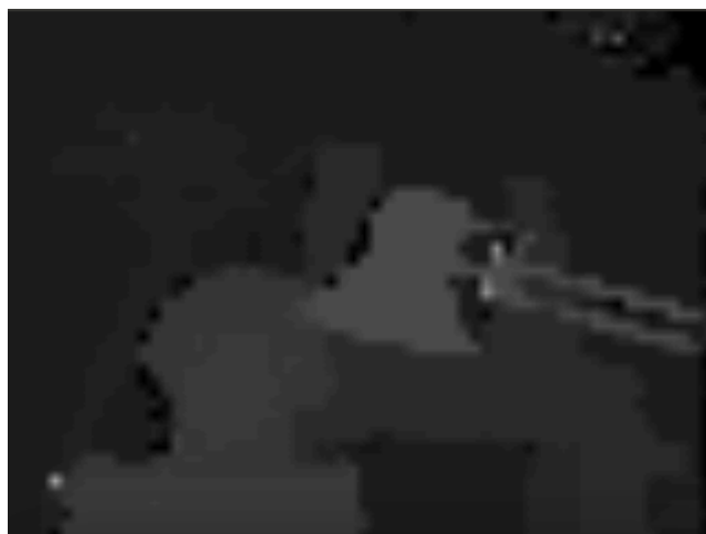
Figura 15– Mapa de disparidade obtido pelo método Semi-Global Matching da API do OPENCV.
